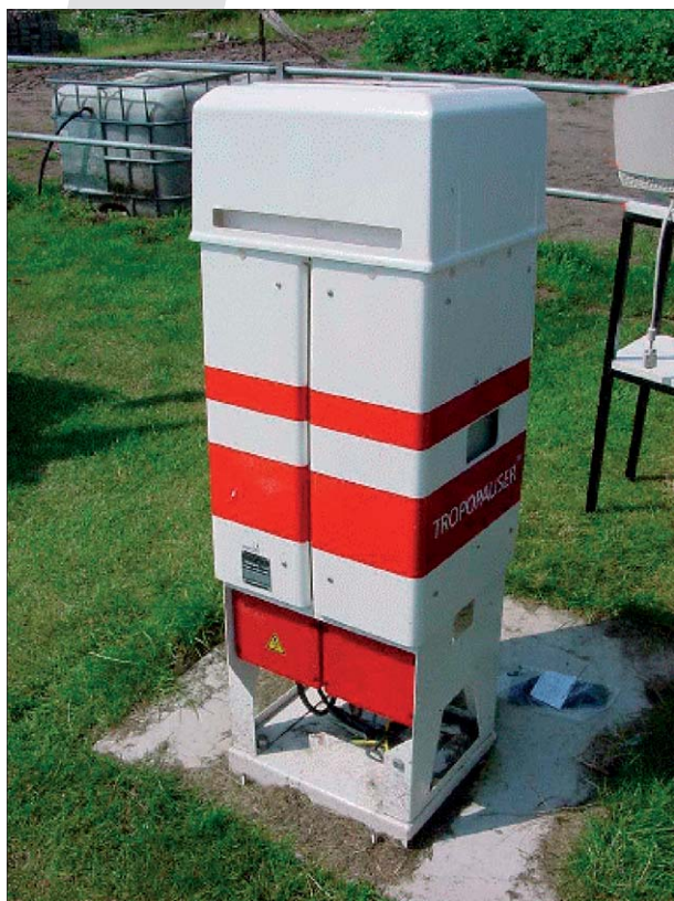
Fig.3 De LD40 wolkenhoogtemeter en een schematische tekening van de belangrijkste onderdelen van de sensor.
