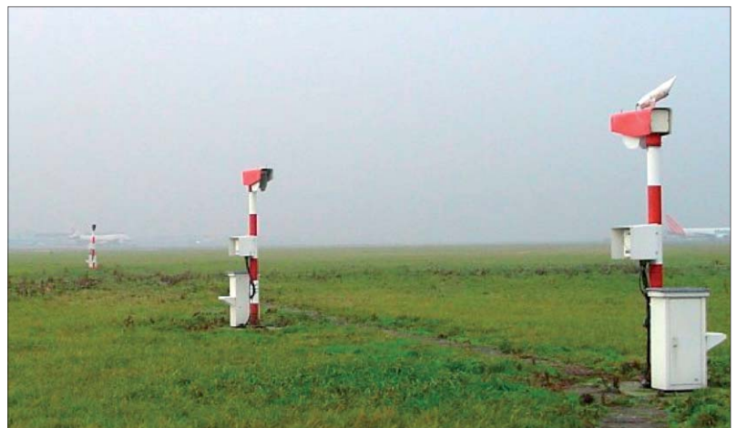
Figuur 1b. Opstelling transmissometer (links twee ontvangers en rechts de zender met daarop de achtergrondhelderheidsmeter), Locatie Schiphol
